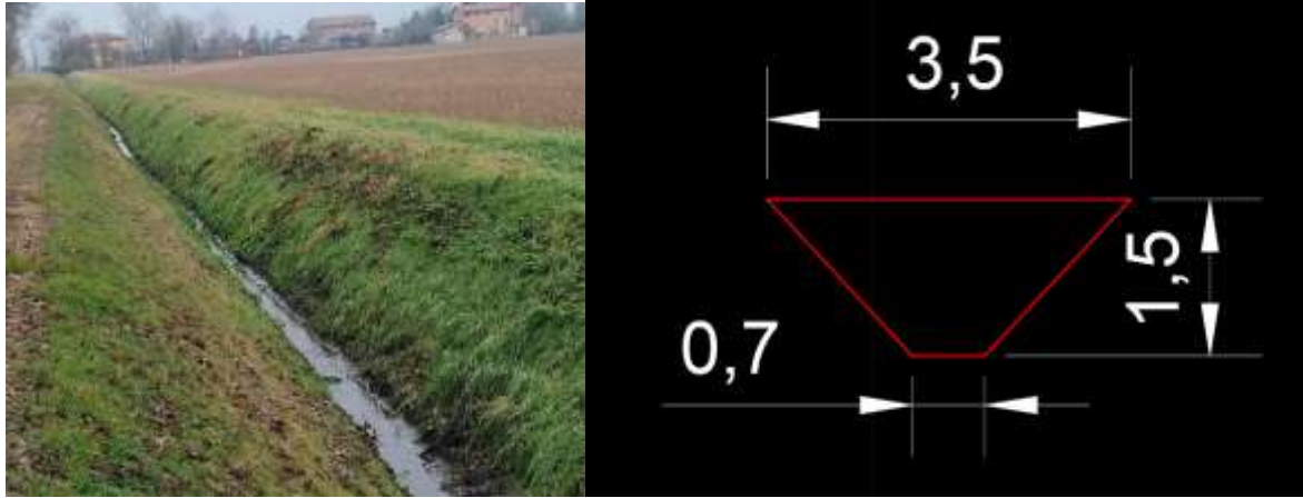
Fig. 3.6.1 – Sezione del Cavo Fossetta delle Larghe in corrispondenza della chiusura del bacino considerato (misure in metri)
